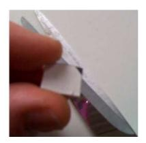
**3.** Mit einer scharfen und stabilen Schere sauber entlang der inneren weißen Fläche die SIM-Karte zuschneiden.
